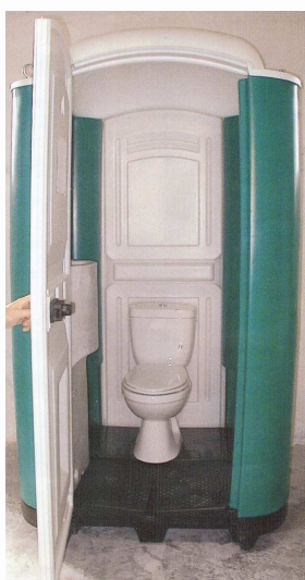
Wc raccordable avec lavabo écoulement DN 110 eau 3/4" - 220 v.
